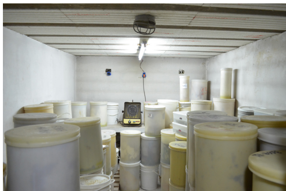
Fotografía 4: Cámara para curado a 38° C (IRAM 1700).
