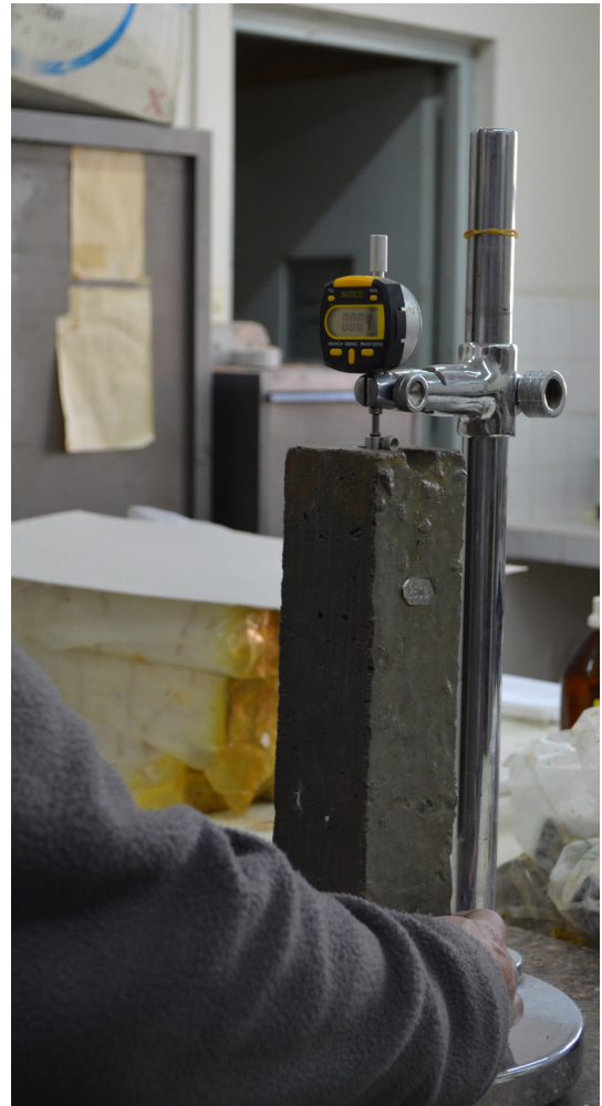
Fotografía 2: Medición del cambio de longitud debido a la RAS en probetas almacenadas en cámara húmeda.
