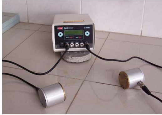
Figura 3.6. Equipo ultrasónico digital.
